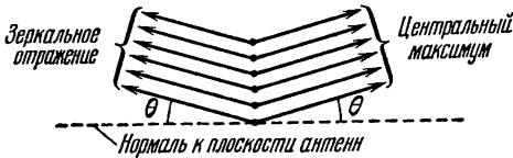
Рис. 9.18. Направления интерференционного максимума для антенн, возбуждаемых с фазовыми соотношениями рис. 9.17.
